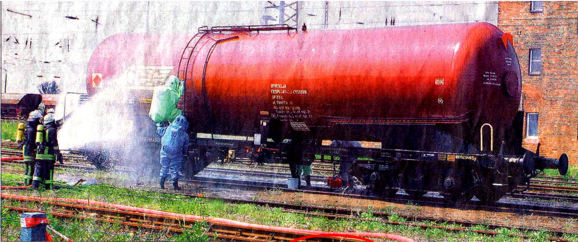
Der lecke Wagon fasst rund 50 000 Liter der hochentzündlichen Chemikalie Methyl-tert-Butylether . Mit Wasser wurden die Dämpfe niedergeschlagen.
